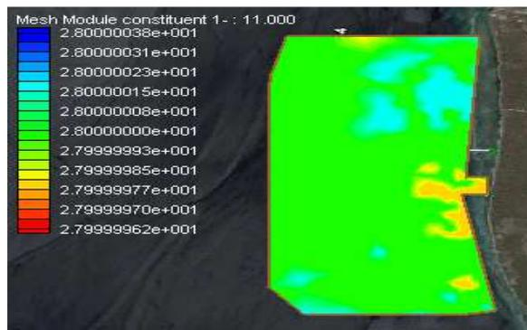
Gambar 7. Detail Simulasi Trend Penyebaran Temperatur di Outlet
